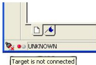
**Gambar 11.** Tanda TMS320C6713 dan CCS3.1 belum terhubung
